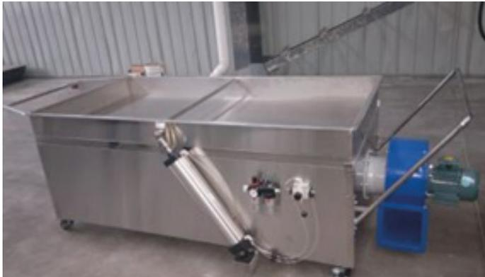
La máquina de enfriamiento permite que el producto terminado regrese a temperatura ambiente, para que se pueda empacar o vender directamente.
