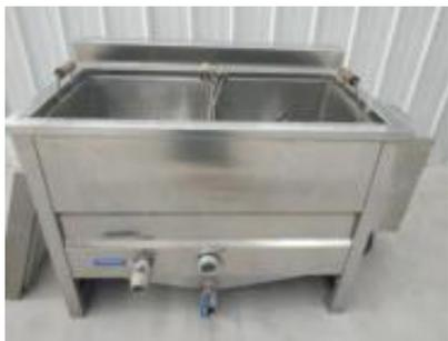
**FUNCIÓN:** Máquina Utilizada para proteger el color y sabor original de la fruta. Equipo esterilizado en agua caliente entre 60-80°C
