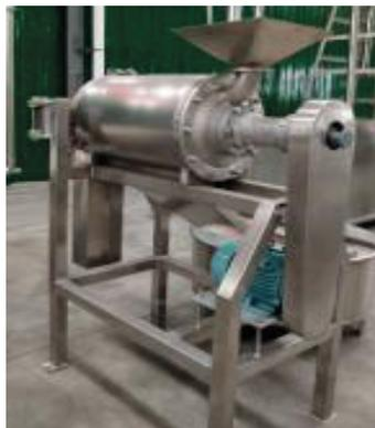
La máquina en forma de monocanal, separación automática de residuos de purines.
