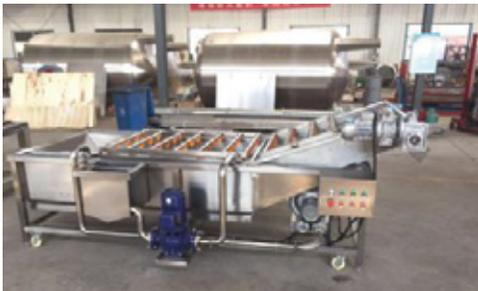
**FUNCIÓN:** Limpia las diferentes frutas bajo presión de burbujas de aire y rociado de agua para una limpieza completa del producto a utilizar.
